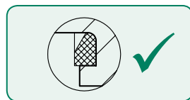
Einzelheit X - Lage der U-Ring Dichtung | Detail X - Position of the U-ring sealing
