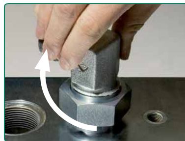
2. Bis zum Druckpunkt einschrauben Screw up to the stop point
