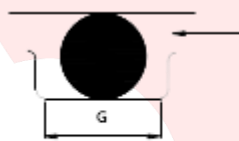
Pressão normal de trabalho suportada pelo anel: não há necessidade de A.A.
