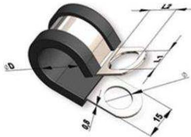
As abraçadeiras **BORRACHA** foram projetadas para fixação, suporte e direcionamento dos tubos ou mangueiras em motores, chassis e estruturas. Sua abertura de borracha EPDM protege os componentes do contato direto com a fita metálica, e seu furo oblongo permite uma montagem mais fácil. São utilizadas em caminhões, ônibus, automóveis e instalações industriais.
