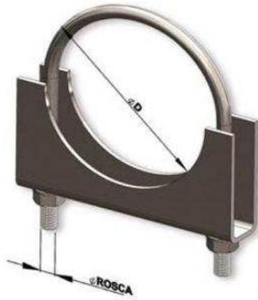
As abraçadeiras da linha "U" são recomendadas para uso em escapamentos de automóveis, caminhões, tratores, fixação de antenas e tubulações, possuindo grande resistência mecânica. São fornecidas com arruelas de pressão, disponíveis em aço carbono, sendo o cavalete zincado e o grampo bicromizado em aço, com alto teor de carbono proporcionando o maior torque dos existentes no mercado.
