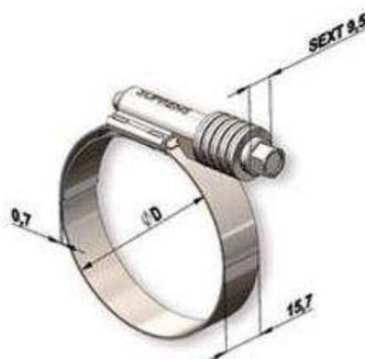
As abraçadeiras da linha **FLEXIL SUPER COM MOLA** têm alta performance de aperto, possuem proteção da região roscada (ponte) e sistema que proporcionam um aperto constante, compensando pequenas variações no diâmetro devido as mudanças de temperatura ou acomodação da mangueira. São recomendadas para uso em locais onde há necessidade de alta performance de aperto, sistemas de arrefecimento (intercoolers) e linha diesel.
