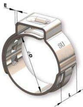
As abraçadeiras da linha **RADIAL** por não apresentarem degraus e/ou desníveis em seu interior, não danificam as mangueiras. São utilizadas na indústria automobilística (dutos de combustíveis) e em sistemas hidráulicos submetidos a altas pressões. Aplicadas com alicates especiais, apresentam circularidade perfeita e constante distribuição das forças radiais, garantindo perfeita vedação do sistema. Possuem grande capacidade de resistência à corrosão.
