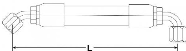
Comprimento do centro da porca até o centro da porca
